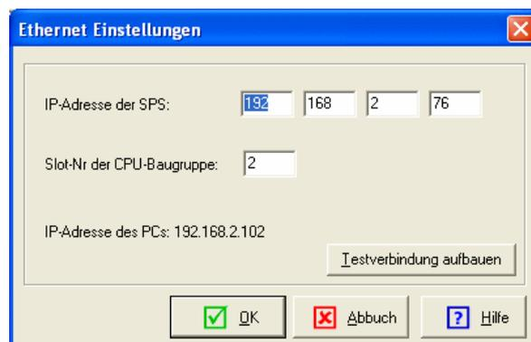
Bild: Einstellungsmöglichkeiten bei der Verbindung "S7-Ethernet"
