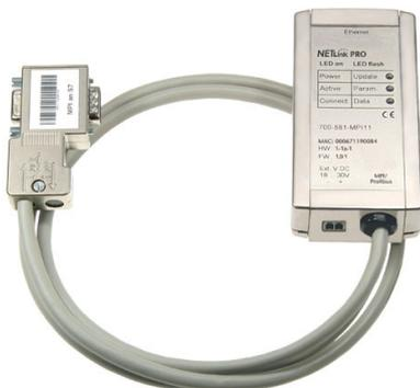
Über diese Verbindungsart kann auf einen MPI- oder Profibusanschluss aufgesetzt werden. Der Netlink-PRO setzt das Ethernetprotokoll auf MPI oder Profibus um. Das Gerät wird an einen Netzwerkhub/switch oder direkt an die Netzwerkkarte im PC/Notebook über ein Crossover-Patchkabel angeschlossen. Der Netlink-PRO hat eine automatische Baudratenermittlung auf dem Profibus-DP und beherrscht bis zu 8 Verbindungen gleichzeitig.
