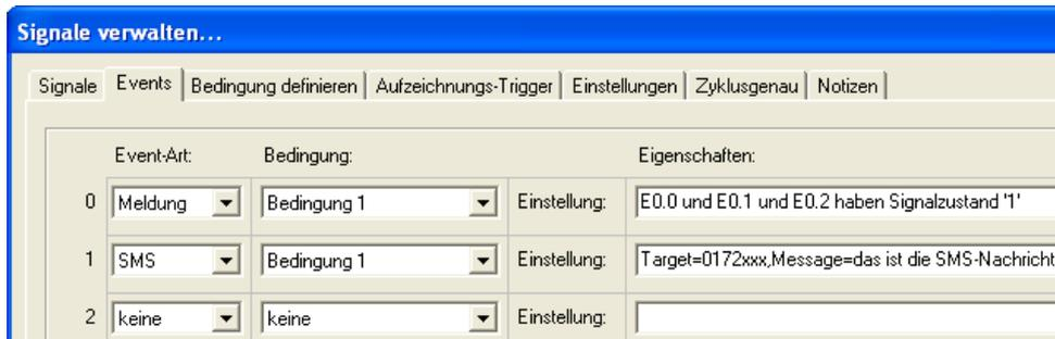
Bild: Es wurde zusätzlich eine SMS definiert
