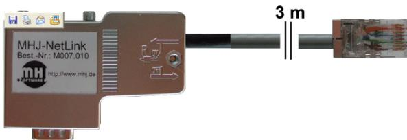
Über diese Verbindungsart kann auf einen MPI- oder Profibusanschluss aufgesetzt werden. Der MHJ-Netlink setzt das Ethernetprotokoll auf MPI um. Das Gerät wird an einen Netzwerkhub/switch oder direkt an die Netzwerkkarte im PC/Notebook über ein Crossover-Patchkabel angeschlossen.
