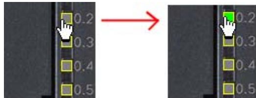
Bild: Umschalten eines digitalen Eingangs mit der Maus
